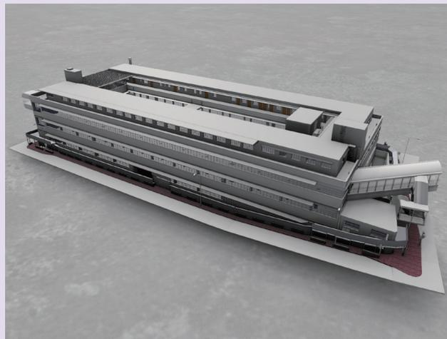
中環街市（圖左）的圖則遍尋不獲後，團隊在前期設計階段決定利用鐳射掃描和點雲方式，協助製作精密的BIM模型（圖右）。
