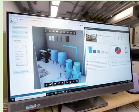
管理人員透過「BIM設施管理系統」的三維模型，便可在電腦平台實時監測建築物內不同系統及設施的狀態，或控制開關。
