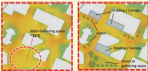
在戶外地方加設遮陽設計，如上蓋或樹蔭等，可帶來降溫效果。左圖為加設遮陽設計前錄得較高的通用熱氣候指數的情況；右圖中綠色部分顯示當加設遮陽設計後，相關指數下降，代表戶外舒適度有所改善。
